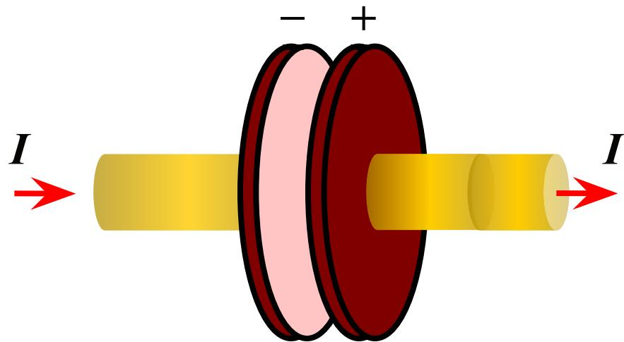
(Циркуляция вектора  $\vec{H}$  по произвольному замкнутому контуру равна сумме токов проводимости, охватываемых этим контуром)
