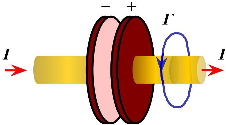
Выберем контур  $\Gamma$ , охватывающий подводящий провод, зададим направление обхода контура.
