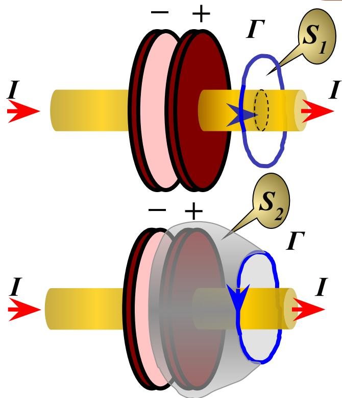
Получается, что циркуляция вектора  $\mathbf{H}$  зависит от формы поверхности, которую мы натягиваем на контур  $\Gamma$ , чего не может быть.
