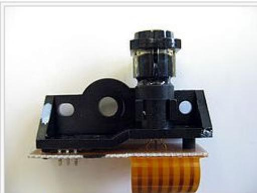
Полупроводниковый лазер, применяемый в узле генерации изображения принтера Hewlett-Packard
