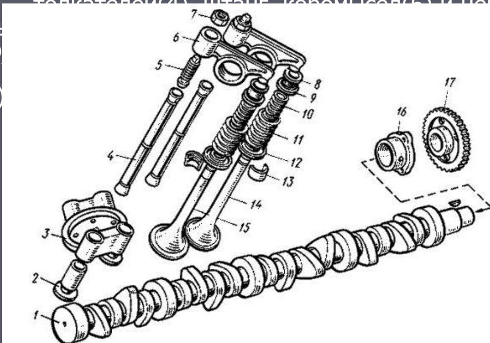
Схема ГРМ: 1 - распределительный вал, 2 - толкатель, 3 - направляющая толкателя, 4 - штанга, 5 - регулировочный винт, 6 - коромысло, 7 - контргайка, 8 - втулка, 9 - тарелка, 10 - пружина внутренняя, 11 - пружина наружная, 12 - шайба, 13 - сухарь, 14 - впускной клапан, 15 - выпускной клапан, 16 - фланец, 17 - шестерня.
