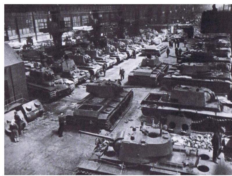
Сборка танков КВ в цехе Кировского завода
