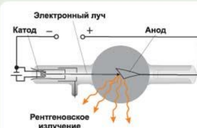
Устройство рентгеновской трубки
