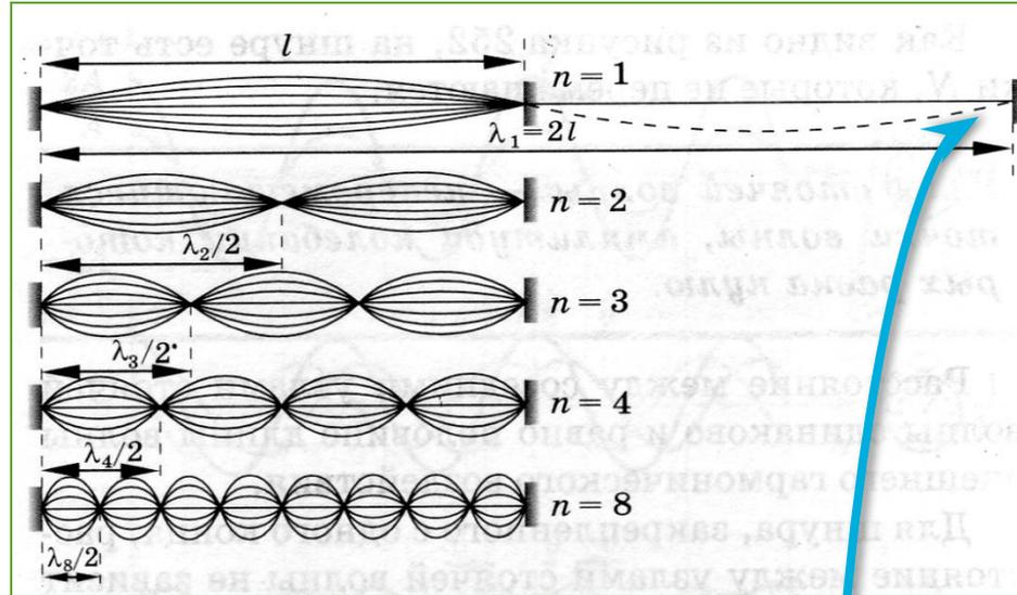
*На длине шнура, закрепленного на концах, укладывается целое число  $n$  полуволн поперечных стоячих волн.*
