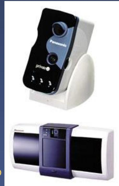
Для сканирования используется обычная видеокамера, данная камера фиксирует изображение крошечных кровеносных сосудов на сетчатке, подсвеченных слабым лазером.
