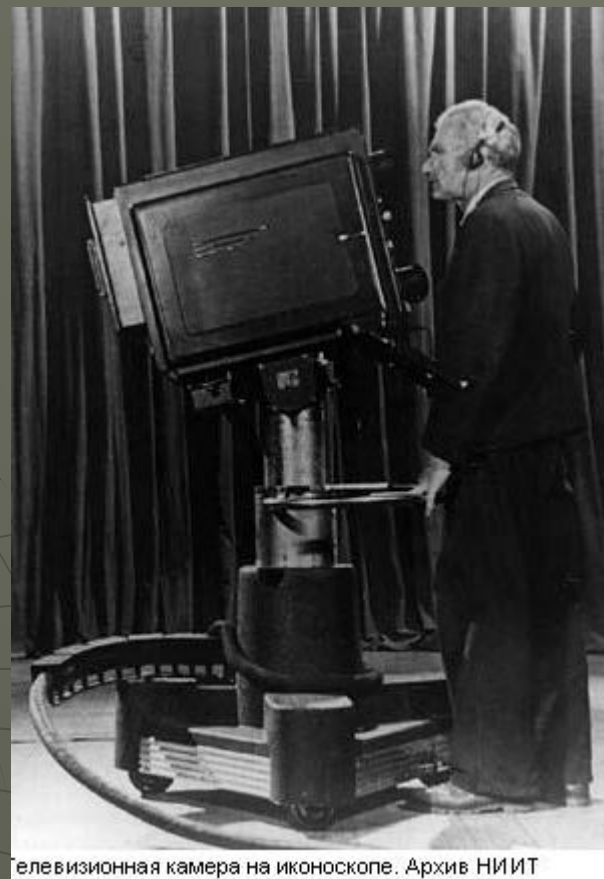
Телевизионная камера на иконоскопе. Архив НИИТ
