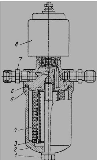
Рис. 10. Электромагнитный клапан:
