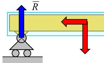
Реакция подвижного шарнира проходит через центр шарнира перпендикулярно оси шарнира и плоскости опирания.
