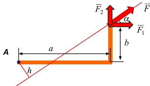
Силу  $\bar{F}$  разложим на составляющие  $\bar{F}_1$  и  $\bar{F}_2$ . Тогда момент силы  $\bar{F}$  относительно точки A можно вычислить как сумму моментов каждой из сил относительно этой точки:
