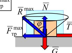
Угол отклонения полной реакции шероховатой поверхности – **угол трения**, равный:
