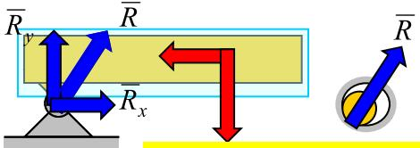
Реакция неподвижного сферического шарнира проходит через центр шарнира и имеет произвольное направление в пространстве.
