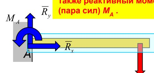
В жесткой плоской заделке возникает три реактивных усилия: две составляющие реактивные силы  $R_x$  и  $R_y$ , а также реактивный момент (пара сил)  $M_A$ .
