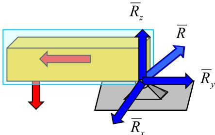
Реакцию неподвижного сферического шарнира можно разложить на три составляющие, например,  $R_x$ ,  $R_y$ ,  $R_z$ , параллельные координатным осям.
