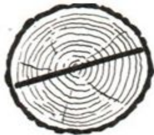
Маркировка круглых лесоматериалов 2-го сорта диаметром 14, 24, 34 см и т.д.
