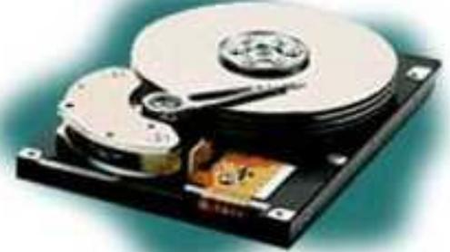
Предназначен для постоянного хранения той информации, которая более или менее часто используется в работе: программ операционной системы, компиляторов языков программирования, сервисных (обслуживающих) программ, прикладных программ пользователя, текстовых документов, файлов базы данных и т.д. Винчестер значительно превосходит гибкие диски по скорости доступа, емкости и надежности. Емкость жестких дисков измеряется в байтах и меняется в широких пределах от 20Мб до 300Гб!
