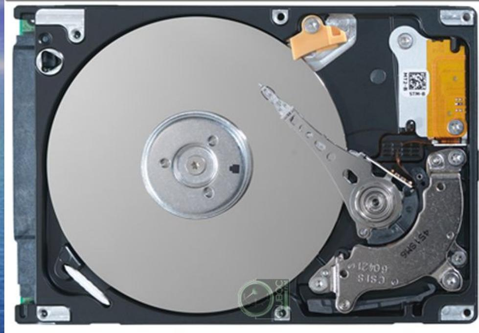
Основные принципы работы жесткого диска мало изменились со дня его создания. Устройство винчестера очень похоже на обыкновенный проигрыватель грампластинок.
