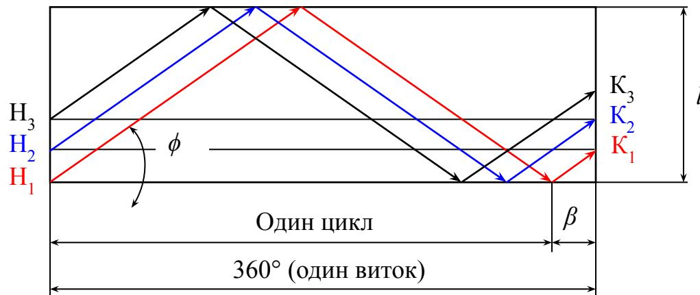
Совершив один оборот вокруг каркаса, провод возвращается в положение, отличающееся от исходного на угол  $\beta$ . Это угол выбирается таким, чтобы каждый последующий виток находился рядом с предыдущим.
