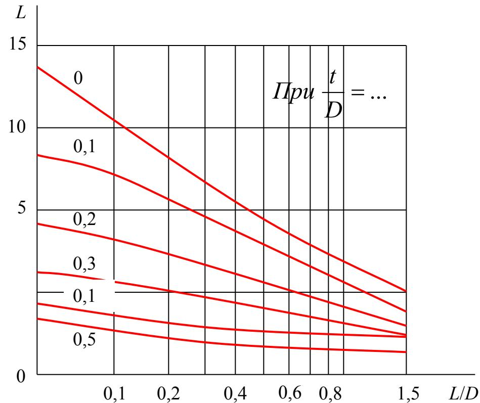
При расчёте катушки индуктивности сначала задают геометрические размеры катушки и определяют коэффициент  $L_0$ , а затем по заданной величине индуктивности находят число витков
