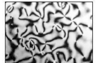
Рідкий кристал смектичного структурного типу.
