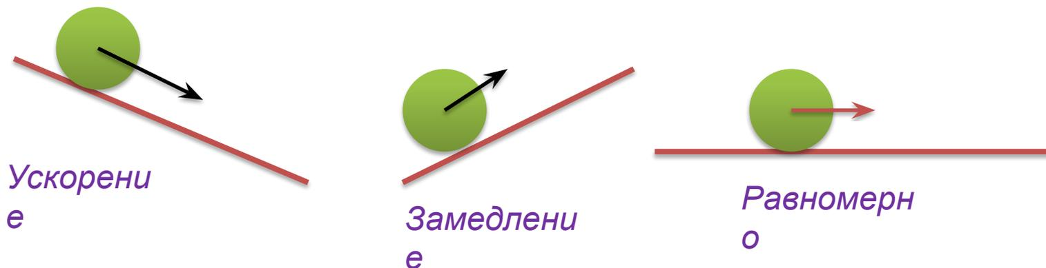
Наклон плоскости к горизонтали является причиной ускоренного движения тела, движущегося вниз, и замедленного движения тела, движущегося вверх по наклонной плоскости.
