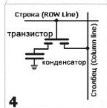
Устройство одной ячейки памяти
