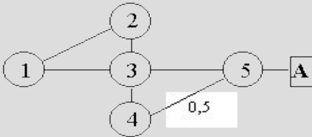
Кружками обозначены маршрутизаторы, прямоугольником – сеть назначения А. Маршрутизатор (3) получает от (5) элемент вектора расстояний ( $A=1$ ), а от (4) – ( $A=1,5$ ). В таблице маршрутизатора (3) узел (5) становится следующим маршрутизатором на пути в сеть А, а узел (4) – вероятным заместителем, так как заявленное им расстояние до А (1,5) меньше полной метрики установленного маршрута (3)-(5)-А, которая равна 2.
