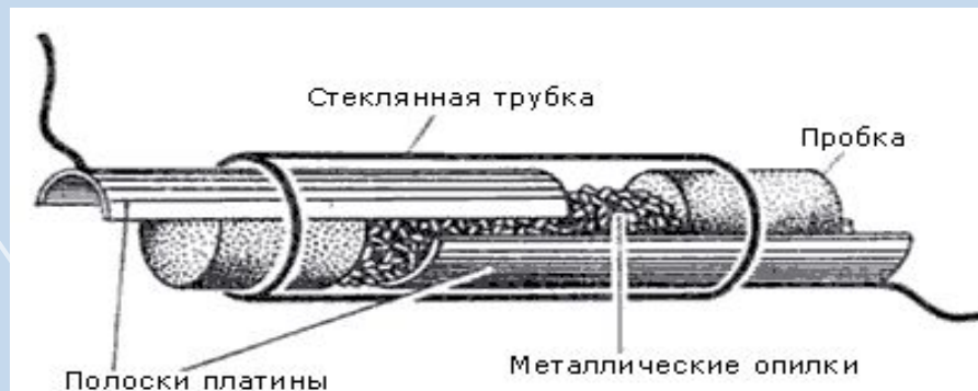
Рис.1. Когерер в грозоотметчике А.С.Попова. На рисунке для наглядности полоски платины раздвинуты.
