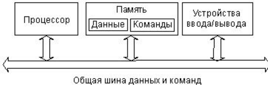
Рис. 1.4. Архитектура с общей шиной данных и команд.
