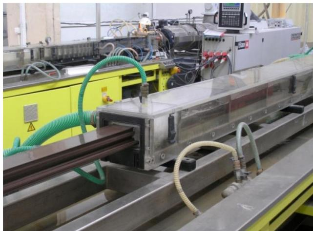
Профильная система Internova производится на заводе с 1992 года на экструдерах австрийской фирмы GREINER. Мощность экструдеров 250, 300 кг/час.
