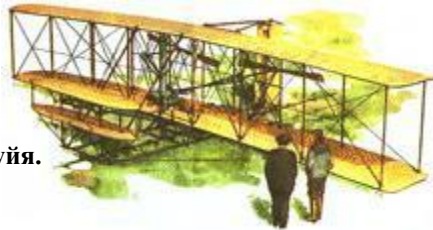
"Флайер" относится к типу биплана с коробчатым крылом.
