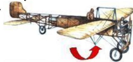
Расчалки, ухудшавшие аэродинамические свойства монопланов.
