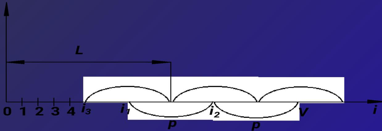
Рисунок 17 Представление определения длин периода  $p$  и отрезка периодичности  $L$
