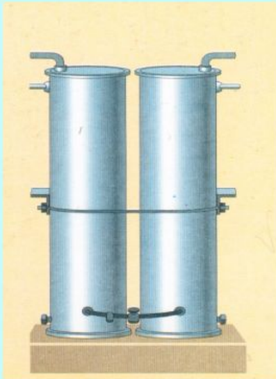
Вертикальный бак аварийного запаса воды
