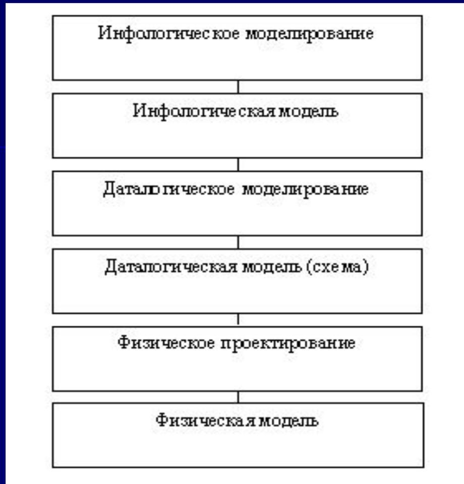
**Рис. 4.7. Иерархическая модель проектирования ГИС**
