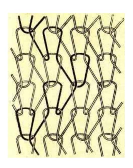
одна нить образует последовательно по одной или две петли в одном петельном ряду, затем в другом, в третьем и т.д., поэтому для образования ряда петель нужна не одна нить, а система нитей, называемая основой.
