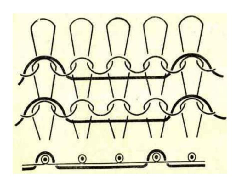
**4.5. Трикотаж плюшевых переплетений** Имеет ворс из удлиненных протяжек, образованных из дополнительных нитей.
