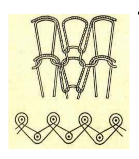
Двойные прессовые переплетения внешне напоминают ластик. Они получены на базе ластика. У фанга - лицевая и изнаночная стороны полотна одинаковы, у полуфанга – неодинаковые. Используют в производстве теплозащитных верхних изделий, спортивной одежды, рейтуз, шарфов и Т.Д.
