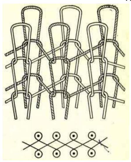
Петельные столбики одного ластика располагаются против петельных столбиков другого ластика, следовательно лицевая и изнаночная стороны полотна одинаковы и образованы из плотно уложенных лицевых столбиков.
