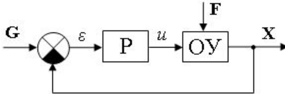
Типовая структурная схема одноконтурной САУ.
