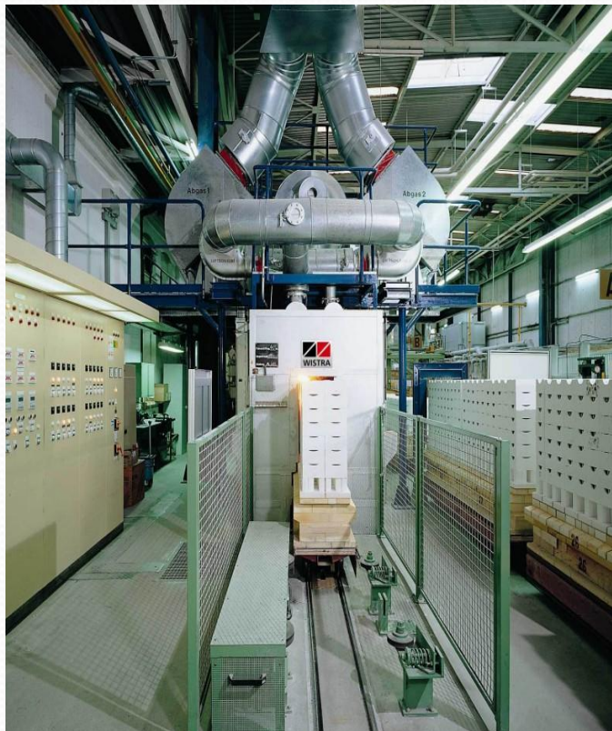
Туннельная печь обжига керамики изделий Wistra 3 (Германия)
