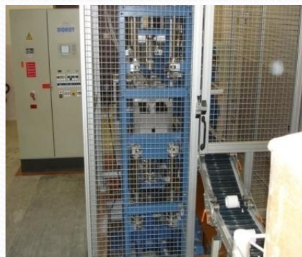
Изостатическое прессование пресс PI-80Z (Dorst,Германия)
