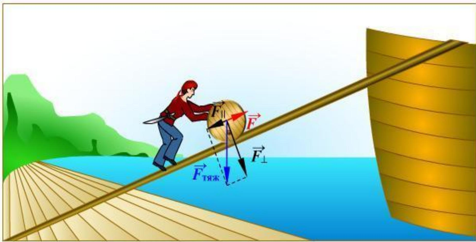
Использование наклонной плоскости для поднятия тяжелых грузов
