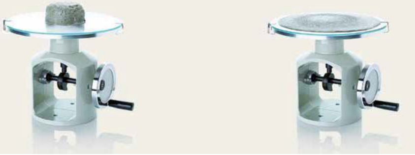
Гидравлическое испытание состава строительного раствора
