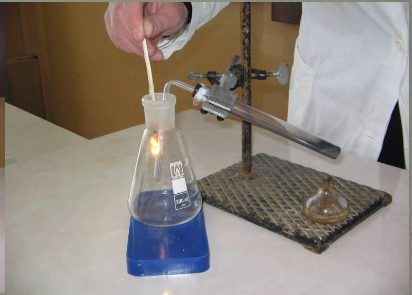
Проверка собранного кислорода
