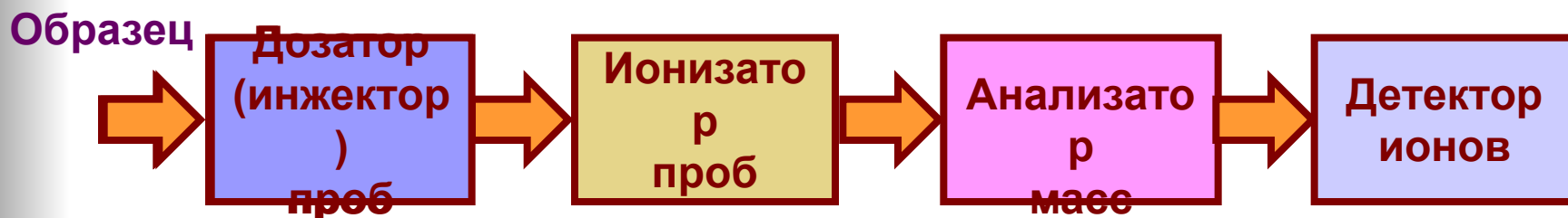
Принципиальная схема масс-спектрометра
