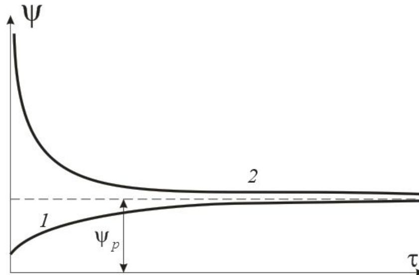
Абсорбция влаги приводит к уменьшению сопротивления изоляции, электрической прочности и увеличению угла диэлектрических потерь.
