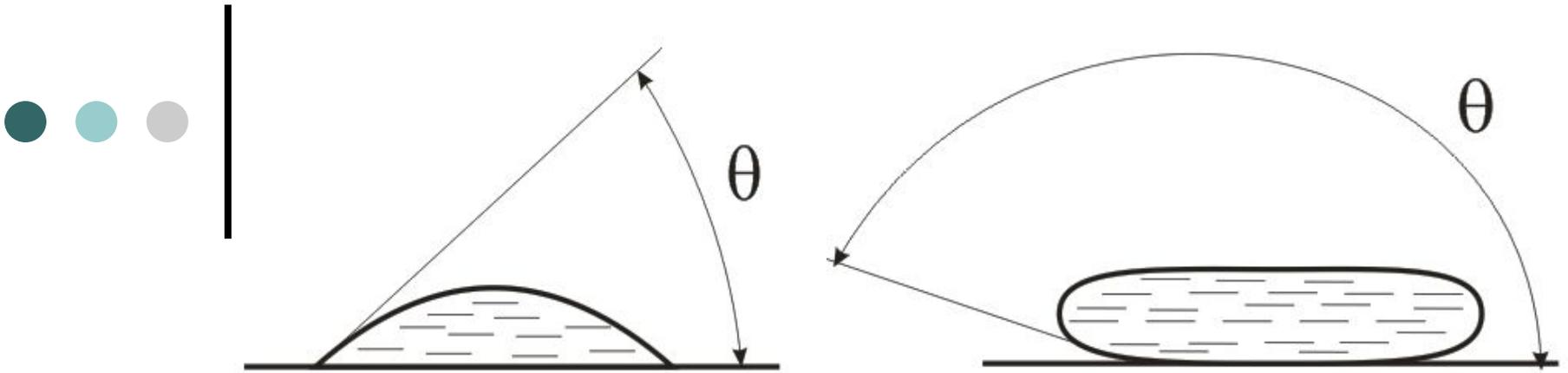
Угол смачивания :  $\theta < 90^\circ C$
