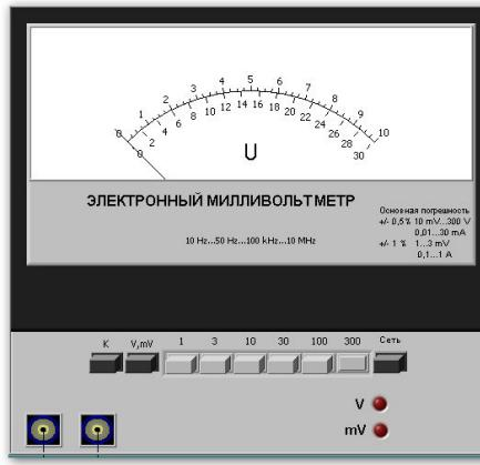
Модель электронного аналогового милливольтметра среднеквадратического значения служит для измерения среднеквадратического значения напряжения в цепях переменного тока синусоидальной и искаженной формы.
