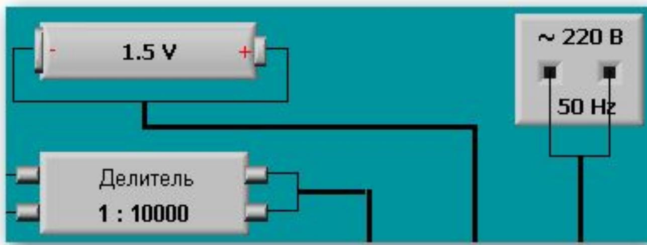
Модель гальванического элемента моделирует работу имеющего источника постоянной электродвижущей силы с ЭДС, равной примерно 1,5 В, и пренебрежимо малым внутренним сопротивлением.
