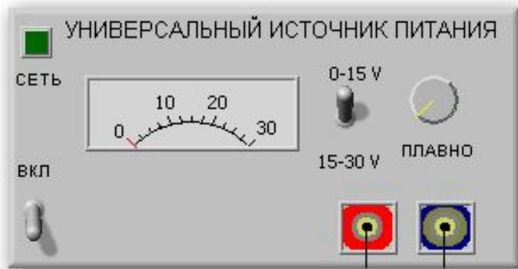
Модель УИП служит для формирования стабилизированного постоянного электрического напряжения с регулируемой амплитудой.
