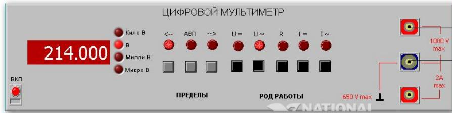
Модель электронного цифрового мультиметра служит для измерения постоянного тока и напряжения, измерения среднеквадратических значений тока и напряжения в цепях переменного тока синусоидальной формы, измерения сопротивления постоянному току. Ниже приведены некоторые характеристики модели:
