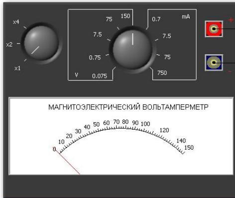
Модель магнитоэлектрического вольтамперметра используется и служит для измерения постоянного напряжения и силы постоянного тока.
