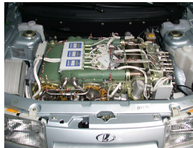
Электромобиль «Антэл-2» с генератором «Фотон МВВ»
