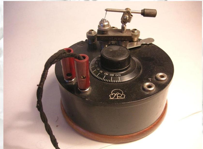
В качестве детектора используют или супергетеродинный радиоприёмник, или кристаллический детектор. Детектор регистрирует сфокусированное на него излучение и полученный сигнал отображает на осциллографе.
