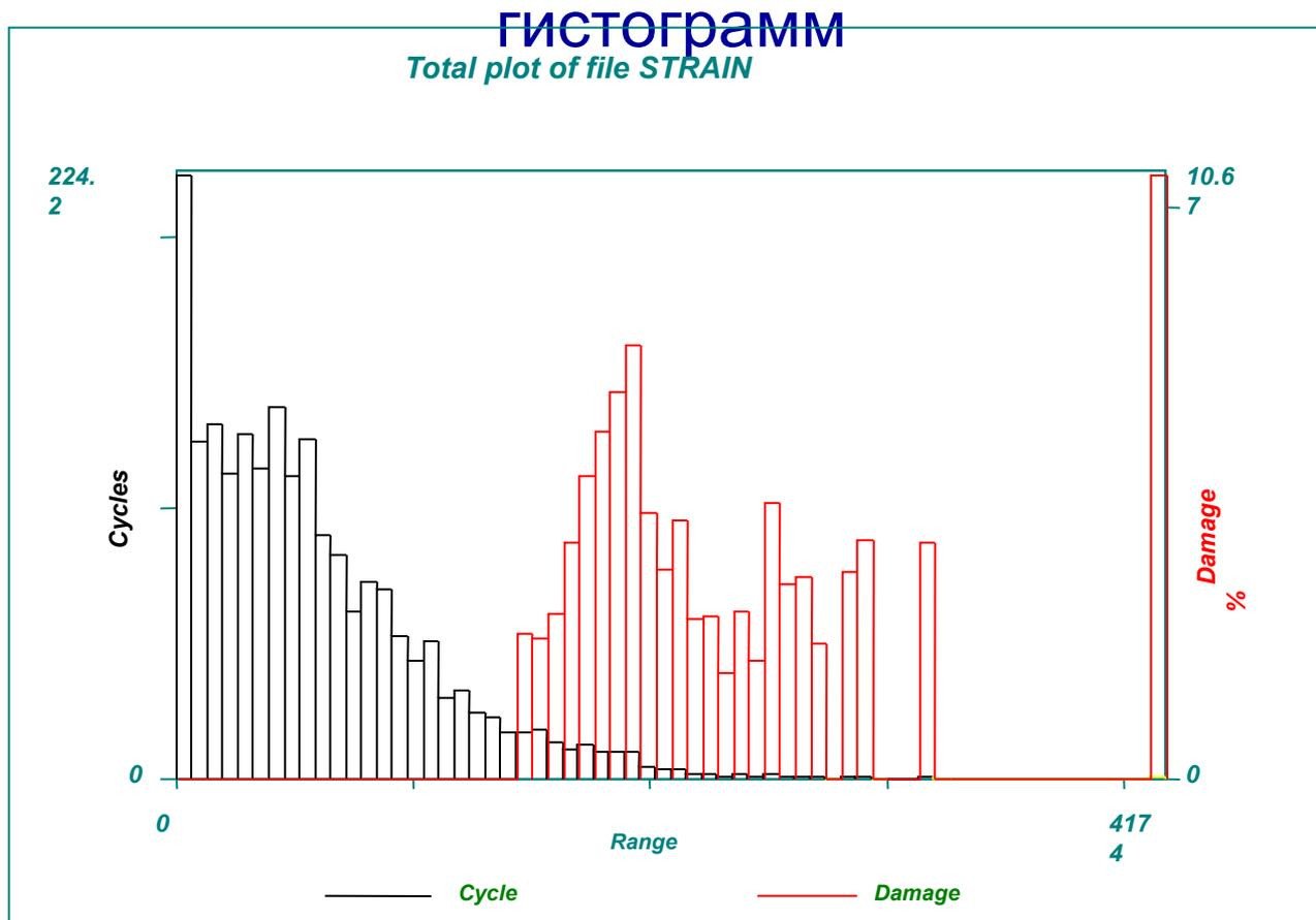
Сравнение количества циклов с распределением повреждений полученным по данным деформационного датчика
