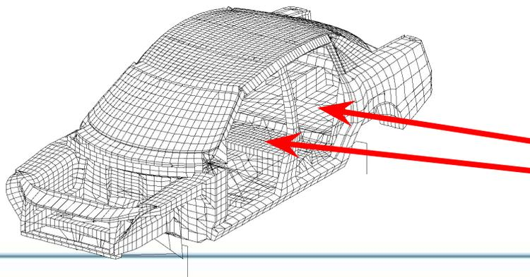
**Отдельные компоненты модели (например, люки, двери) могут представляться в виде суперэлементов, характеристики которых получают экспериментально**
