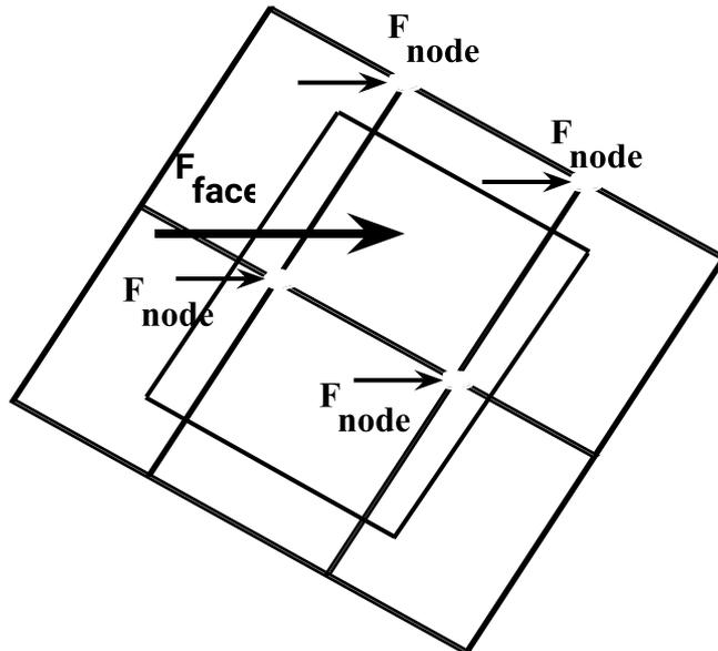
**Зона перекрытия одной грани поверхности взаимодействия и одного эйлерова элемента**
