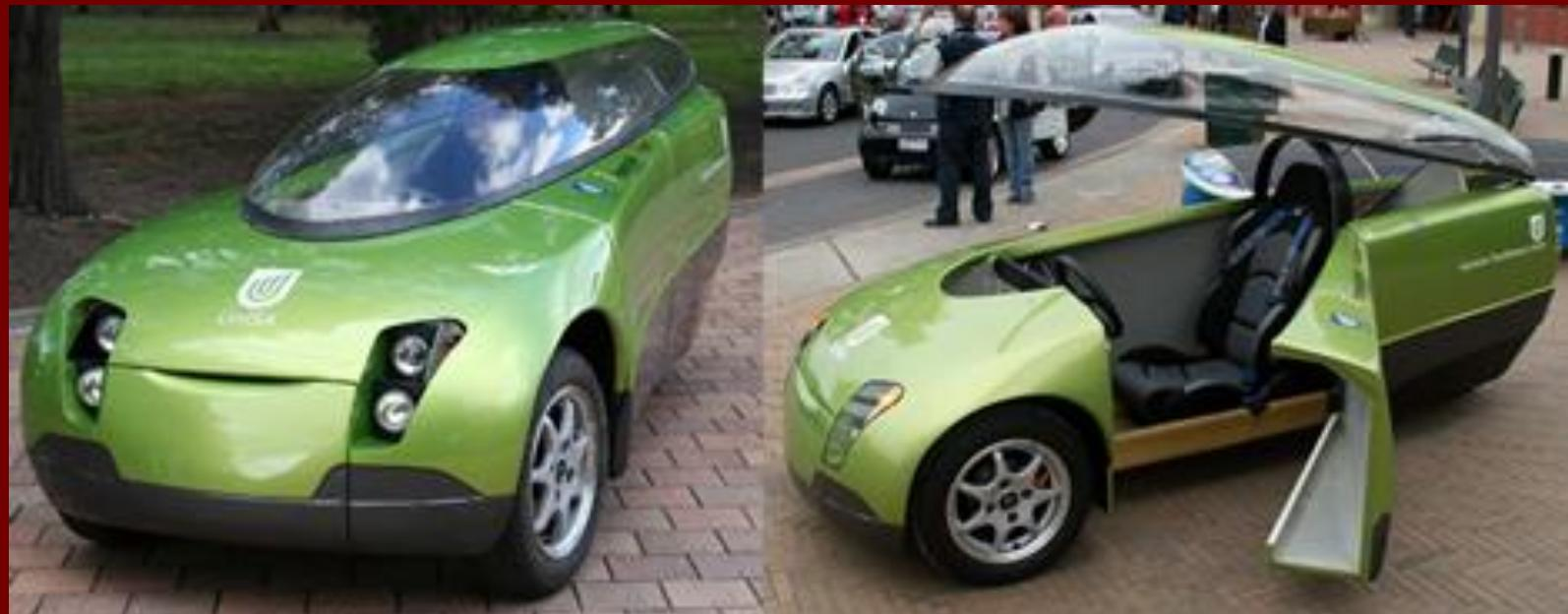
Trev разгоняется с 0 до 100 км/ч за 10 секунд, а максимальная скорость у него 150 км/ч. Он может проехать 150+ км, прежде чем снова нужно будет заряжать его 44-килограммовую литиевую батарею. При этом топливо на 100 км проезда обойдется всего в 85 центов (что в 5 раз меньше, чем расходуют современные автомобили).
