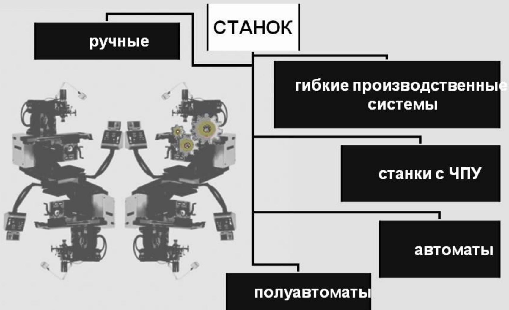
Классификация металлорежущих станков
