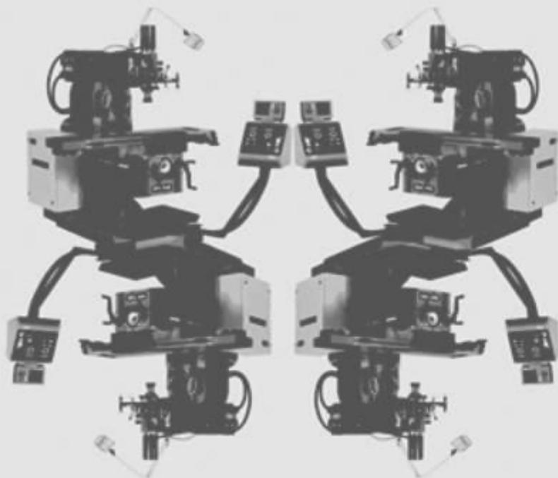
● **Обработка резанием** — это технологический процесс, который осуществляется на металлорежущих станках путём внедрения режущего инструмента в тело заготовки с последующим выделением стружки и образованием новой поверхности.
