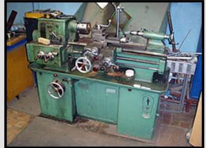
История металлорежущих станков. Считается, что история металлорежущих станков начинается с изобретения суппорта токарного станка. Около **1751 г.** французский инженер и изобретатель **Жак Де Вокансон** первый применил специальное устройство для фиксации резца - устранив таким образом непосредственное влияние руки человека на Формообразование поверхности.
