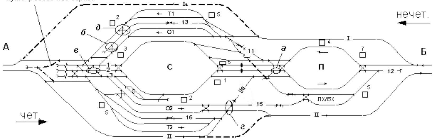
Схема \_\_\_\_\_ сортировочной станции с \_\_\_\_\_ расположением парков и \_\_\_\_\_ расположением главных путей
