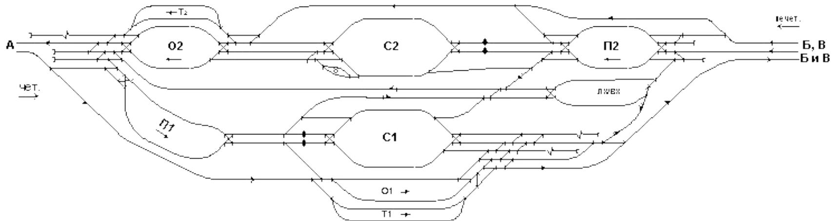
Схема \_\_\_\_\_ сортировочной станции с \_\_\_\_\_ расположением парков \_\_\_\_\_ комплекта и \_\_\_\_\_ расположением главных путей
