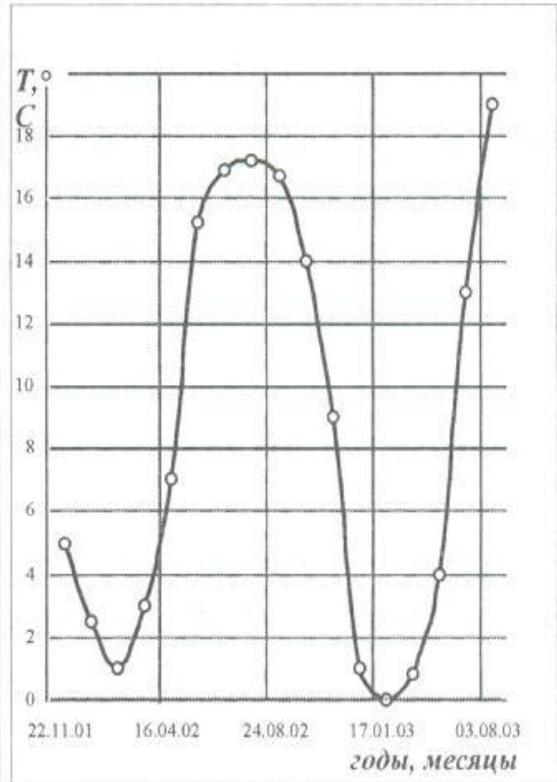
**Закачка в продуктивный пласт больших объемов воды с температурой ниже начальной пластовой может вызвать значительное его охлаждение**
