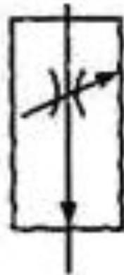
Конструктивно этот аппарат состоит из последовательно включенных редукционного клапана и дросселя. Расход жидкости через регулятор устанавливается дросселем, а постоянство перепада давления на дросселе - редукционным клапаном.
