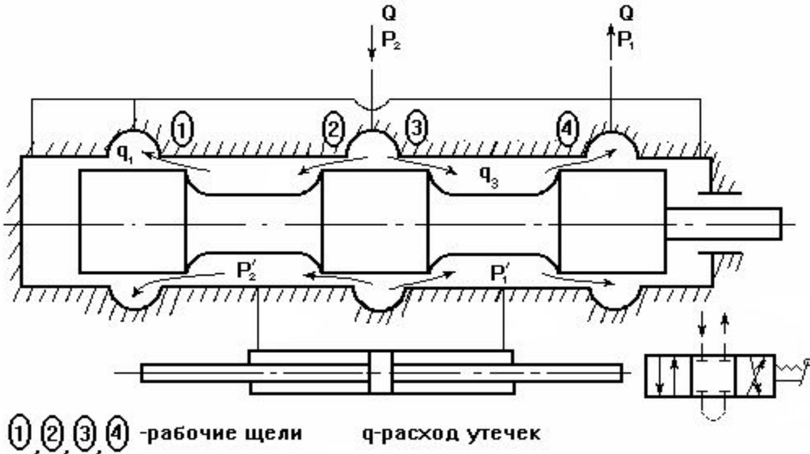
**Золотниковый распределитель** трехпозиционный, четырехлинейный, четырехщелевой, с ручным управлением.
