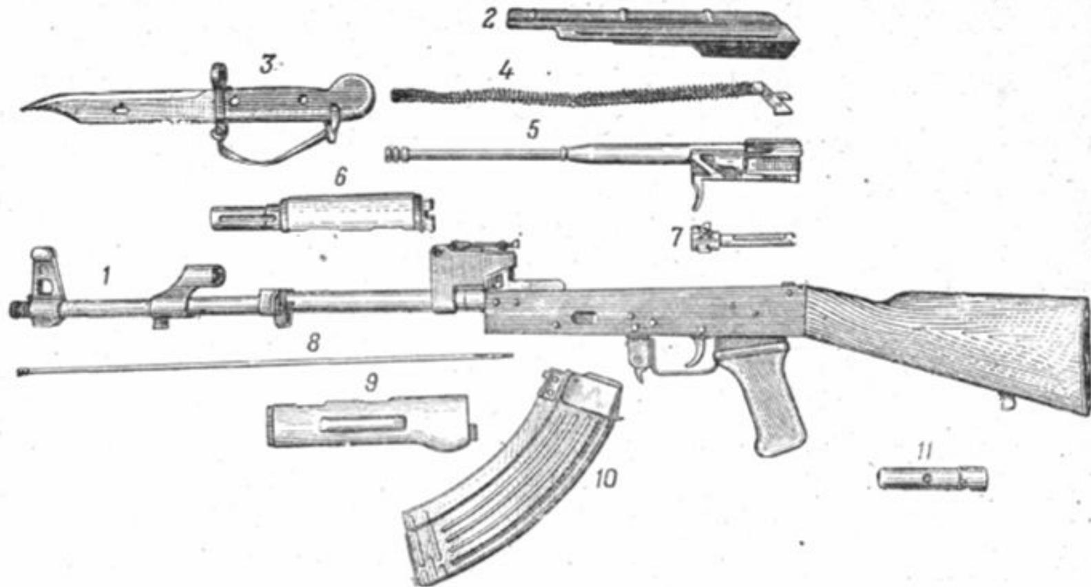
1 — ствол со ствольной коробкой, с прицельным приспособлением и прикладом; 2 — крышка ствольной коробки; 3 — штык-нож; 4 — возвратный механизм; 5 — затворная рама с газовым поршнем; 6 — газовая трубка со ствольной накладкой; 7 — затвор; 8 — шомпол; 9 — цевье; 10 — магазин; 11 — пенал с принадлежностью
