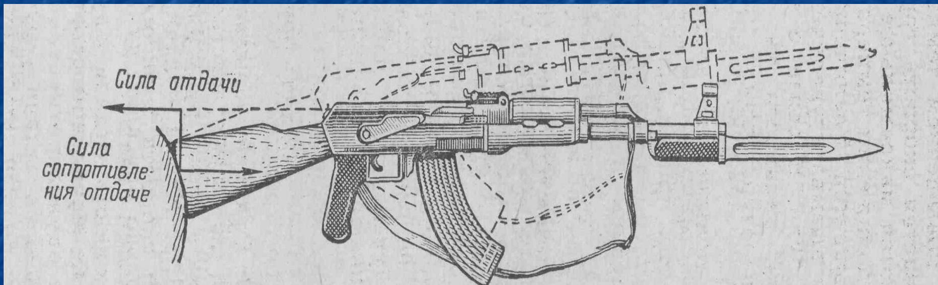
Рис. 2 Подбрасывание дульной части ствола оружия вверх при выстреле в результате действия отдачи.
