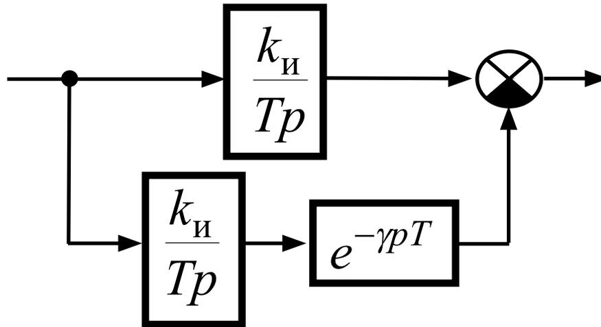
Поскольку передаточные функции формирующего элемента и непрерывной части описываются обычным преобразованием Лапласа, то их последовательное соединение обычно называют **приведенной непрерывной частью**
