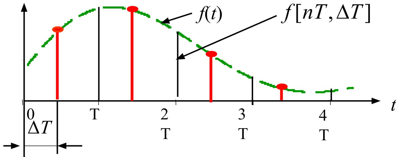
Смещённые решетчатые функции позволяют путём изменения смещения оценить поведение непрерывной функции внутри периода квантования
