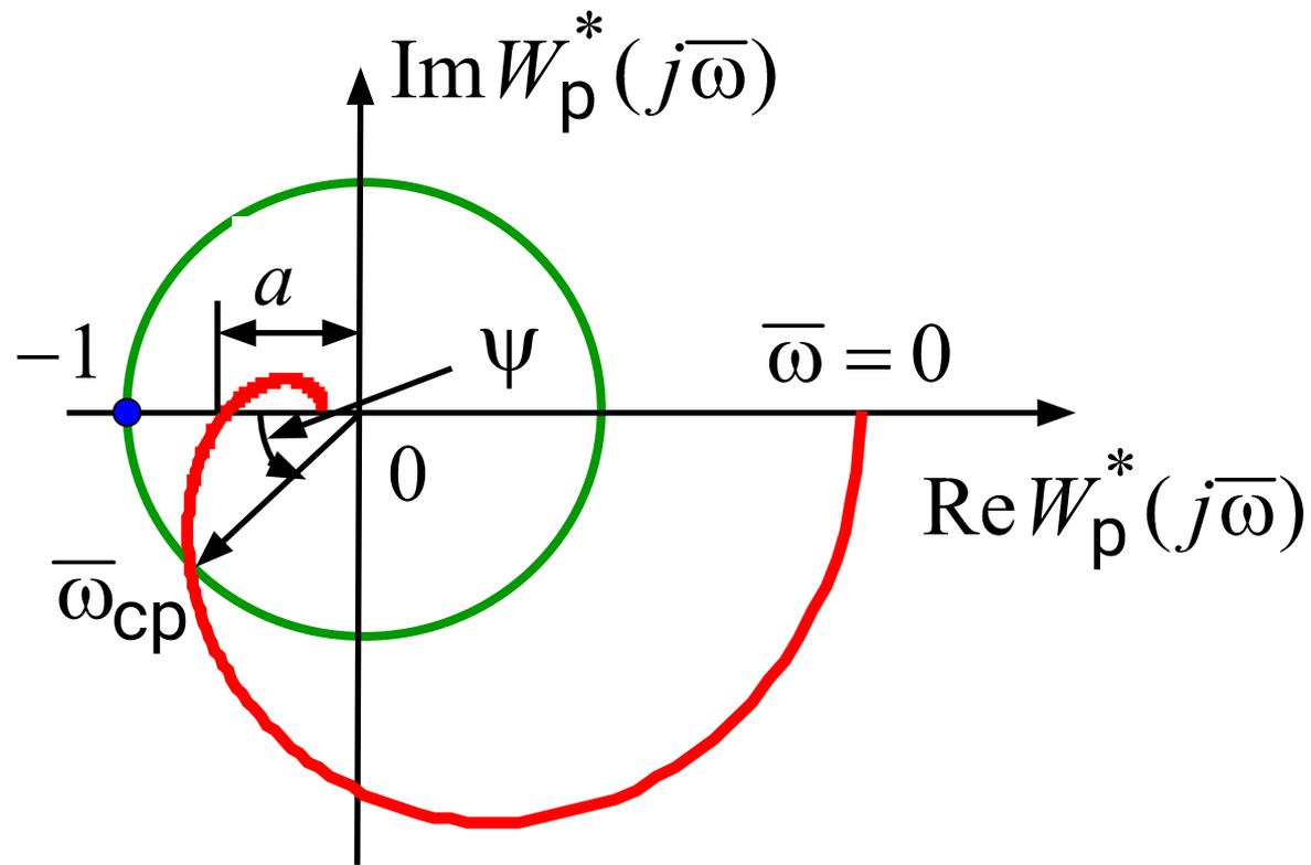
Частоты, при которых  $\varphi^*(\bar{\omega}) = -\pi$ , называют **критическими**, а частоту, при которой определяется запас устойчивости по амплитуде, называют **граничной**. Если критическая частота одна, то она является граничной
