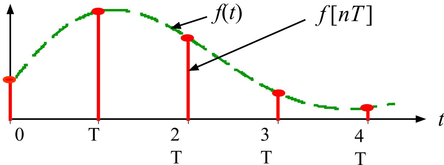
Любой непрерывной функции  $f(t)$  будет соответствовать единственная решетчатая функция  $f[nT]$ , но одной решетчатой функции может соответствовать множество непрерывных функций
