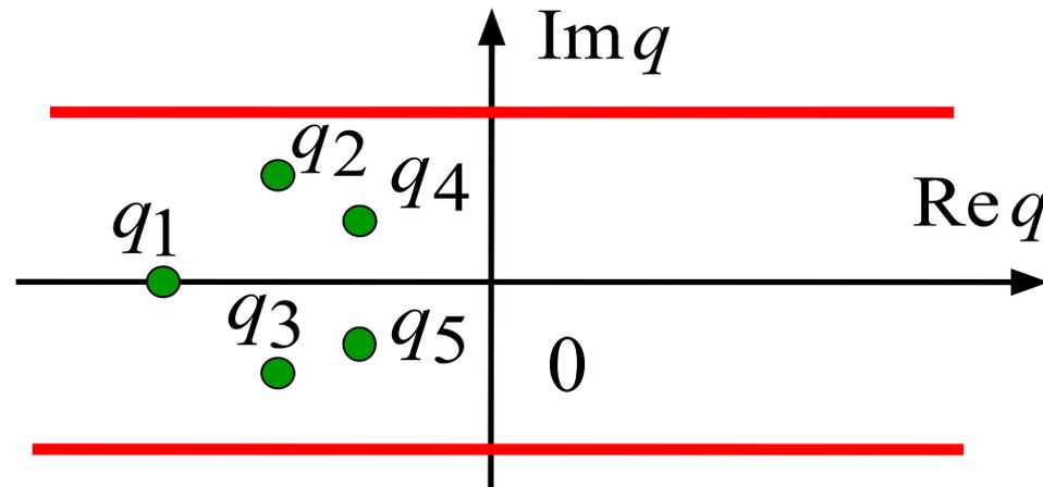
Вывод: при описании САУ с АИМ дискретным преобразованием Лапласа, то необходимое и достаточное условие ее устойчивости аналогично такому же условию для линейных непрерывных систем. Отличие – полоса  $-\pi < \text{Im } q \leq \pi$
