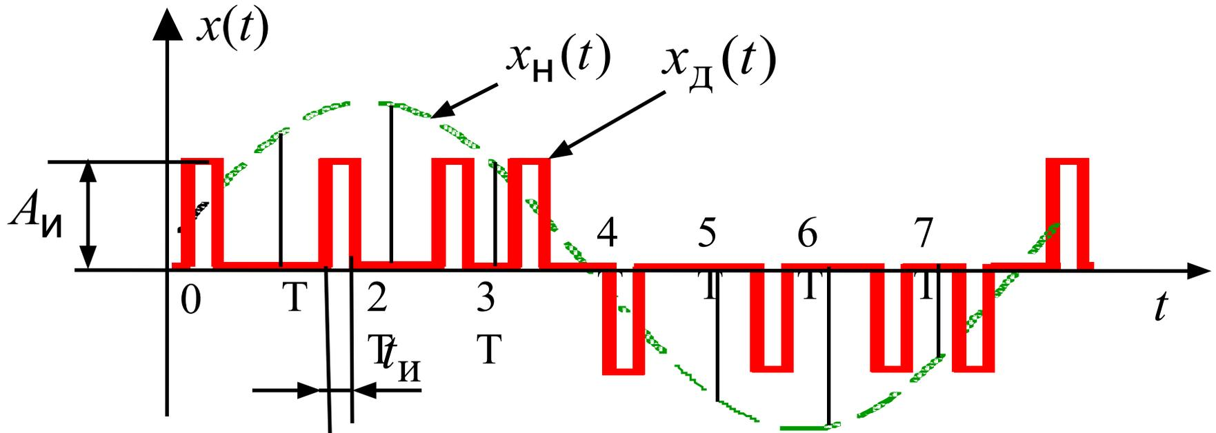
Если при изменении полярности модулирующего сигнала может изменяться полярность импульсов то это – **двухтактная модуляция**, если не изменяется то это – **однотактная модуляция**
