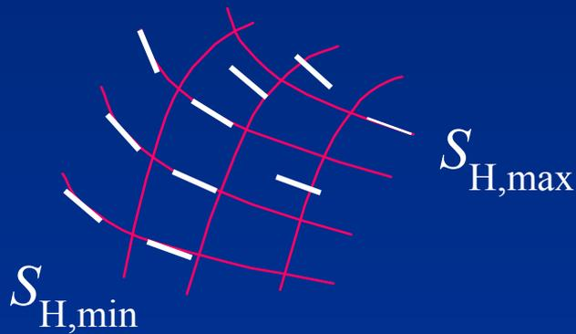
Модельный пример построения плоской сетки взаимно ортогональных ТГН по заданным дискретным ориентациям максимального сжимающего напряжения
