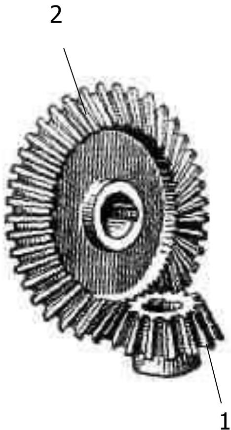
**2.** *Передача вращения между валами с пересекающимися осями (лежащими в одной плоскости) осуществляется коническими колесами. Форма зубьев может быть прямая, косая и криволинейная. На рисунке показана коническая передача с прямыми зубьями.*
